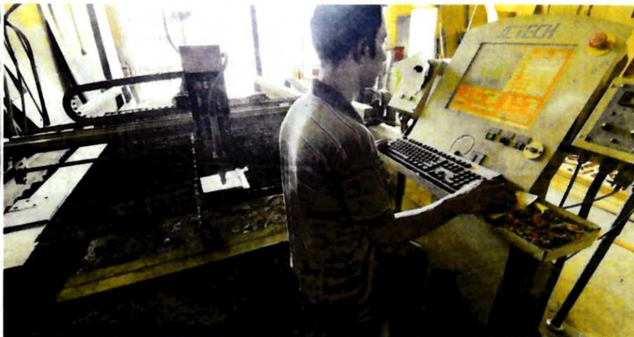
PENGENDALIAN mesin CNC sangat mudah dengan hanya perlu memasukkan beberapa jenis kod yang akan membentuk corak tertentu.
