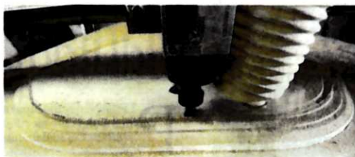
SELAIN pemotongan rata yang menghasilkan produk dua dimensi, mesin CNC juga mampu mengukir sesuatu bahan menjadi ukiran tiga dimensi.
